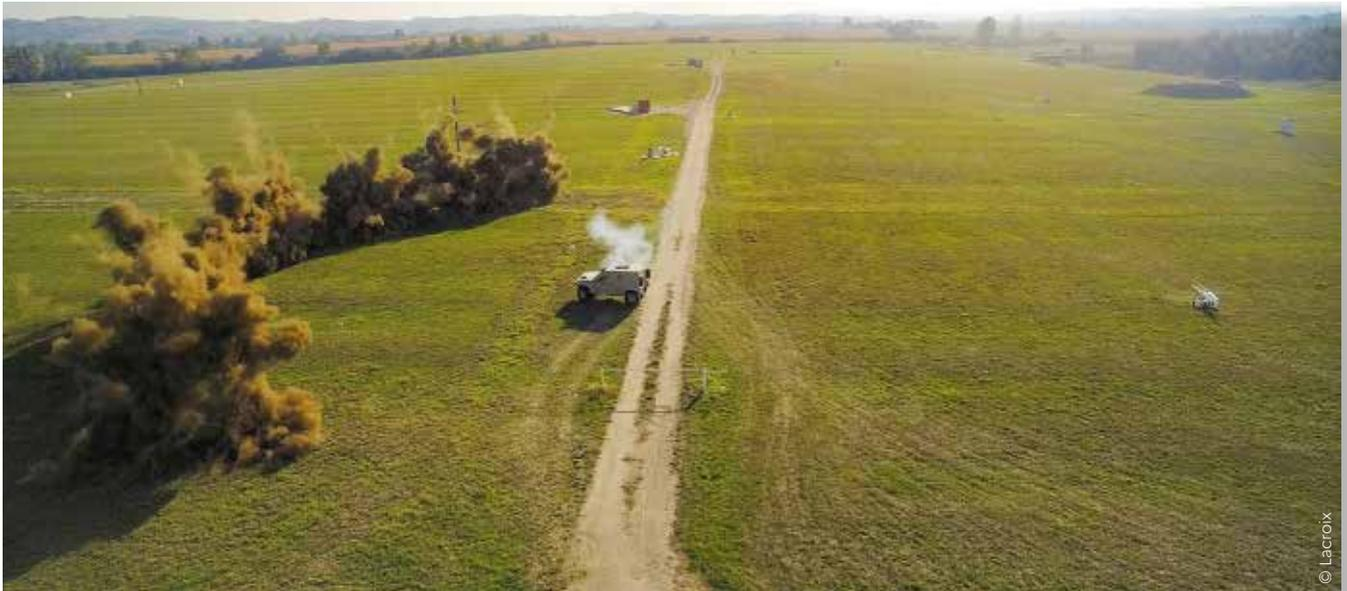
PRONOIA étudie un nouveau système orientable d'autoprotection par fumigènes destiné aux véhicules blindés légers. Il permet le panachage des types de fumigènes et la protection du toit, et inclut une capacité de détection multi-menaces : détection d'alerte laser (DAL), détection de départ missiles et localisation acoustique de tirs et drones. Les évaluations de la fonction DAL face aux télé-
