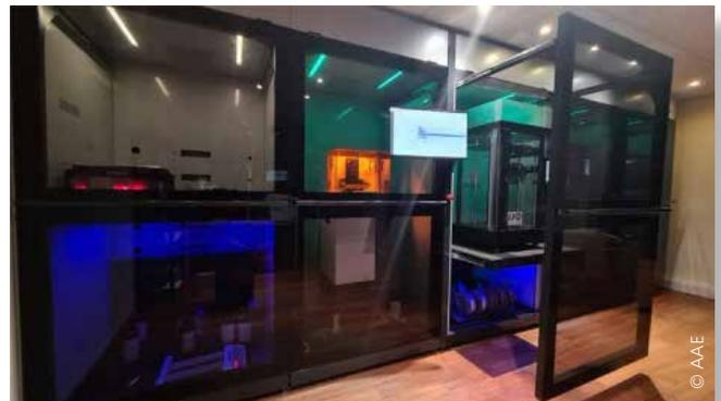
Dans le cadre du Soutien Opérationnel 4.0, l'armée de l'Air et de l'Espace a mis en œuvre le projet SmartFarm. Ce dernier a permis le développement d'une micro-usine modulaire, capable d'accueillir plusieurs imprimantes 3D dédiée à la fabrication additive.
