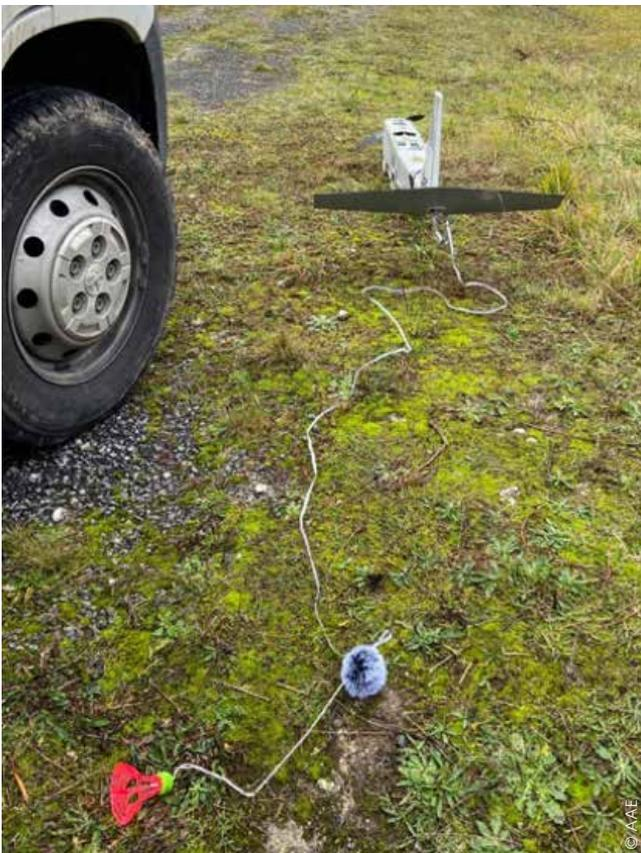
Intégration de capteurs acoustiques sur drone PUMA
