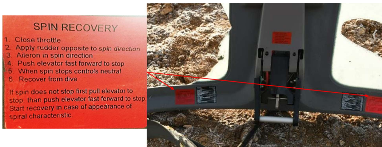
Figure 9 : procédure de sortie de vrille affichée sur la verrière du Grob 120
