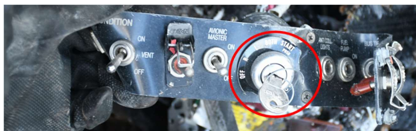
Figure 19 : sélecteur de démarrage en position magnétomètre droit
