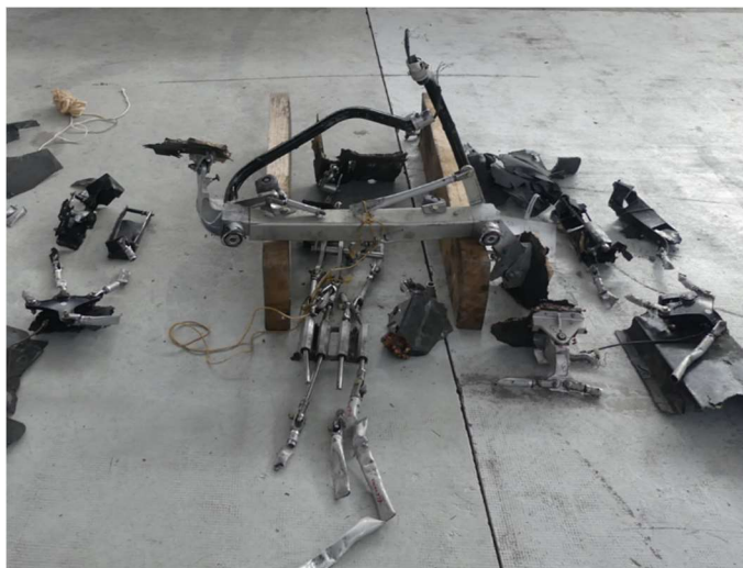
Figure 13 : reconstitution des commandes de vol
