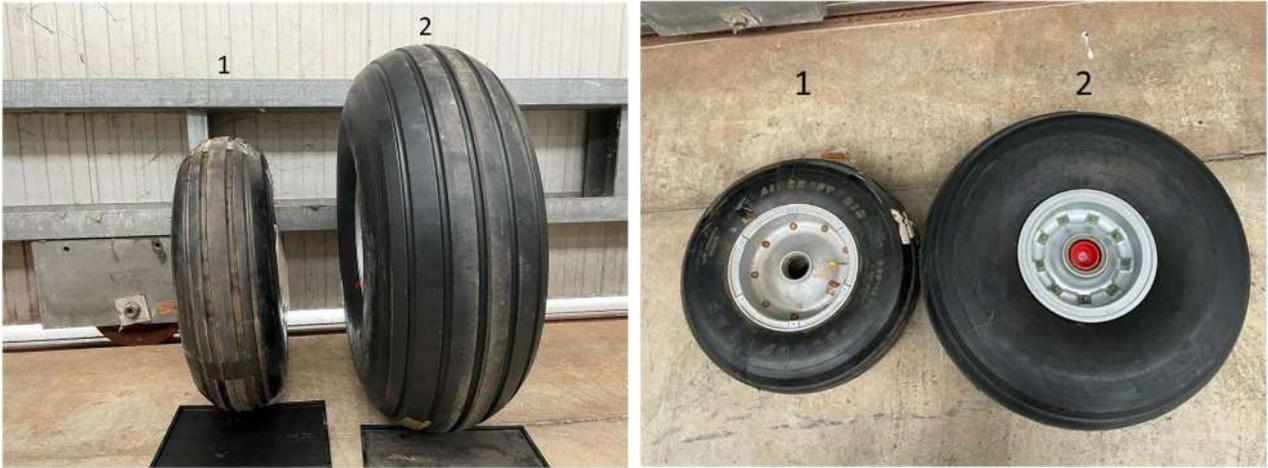
Figure 8 : comparaison entre une roue standard (1) et une roue du kit IFG (2)
