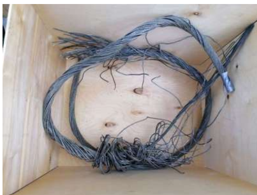
Figure 9 : vue d'un des deux morceaux du conducteur au niveau de la rupture
