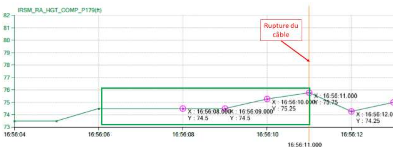
Figure 15: hauteur de l'aéronef au moment de l'évènement
