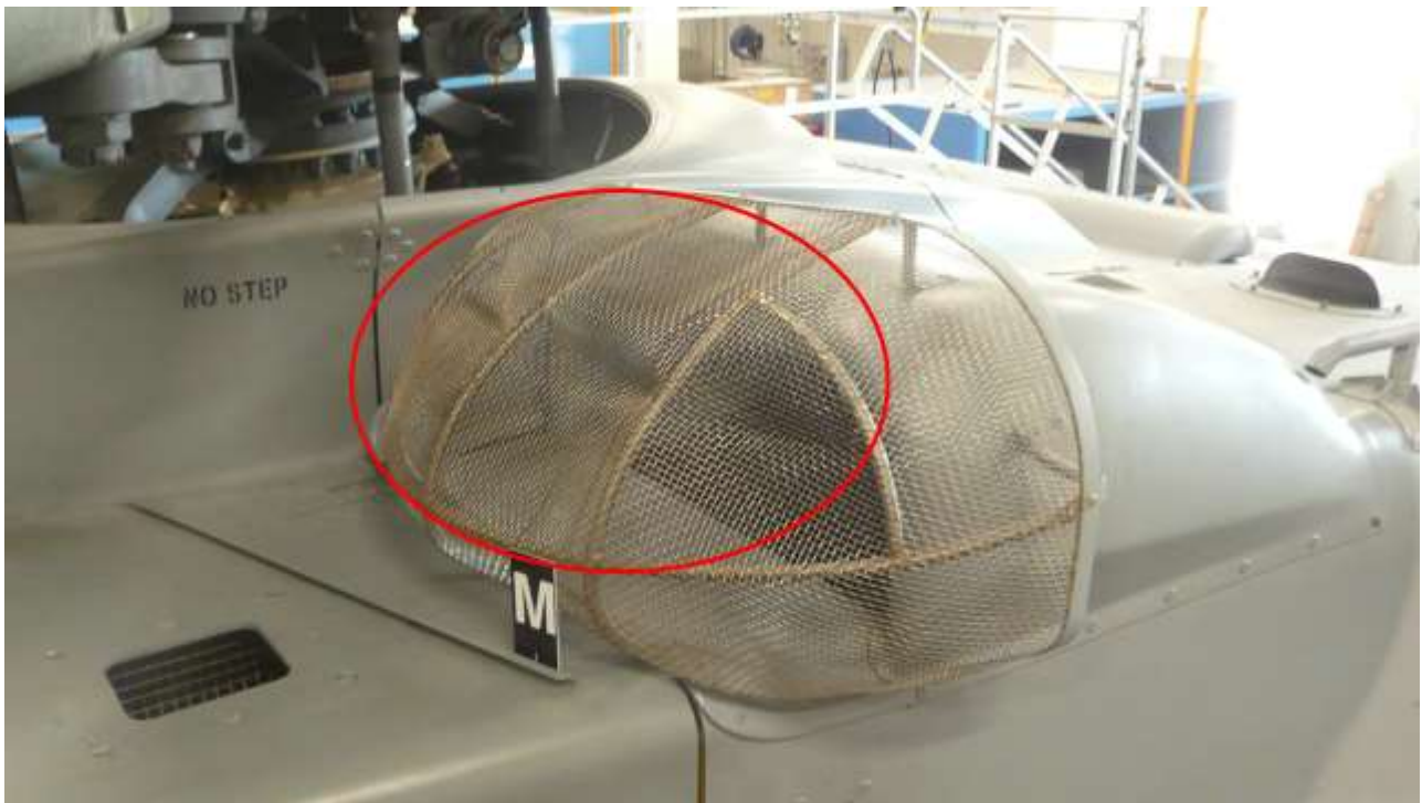
Figure 9 : vue de la grille de l'entrée d'air gauche
