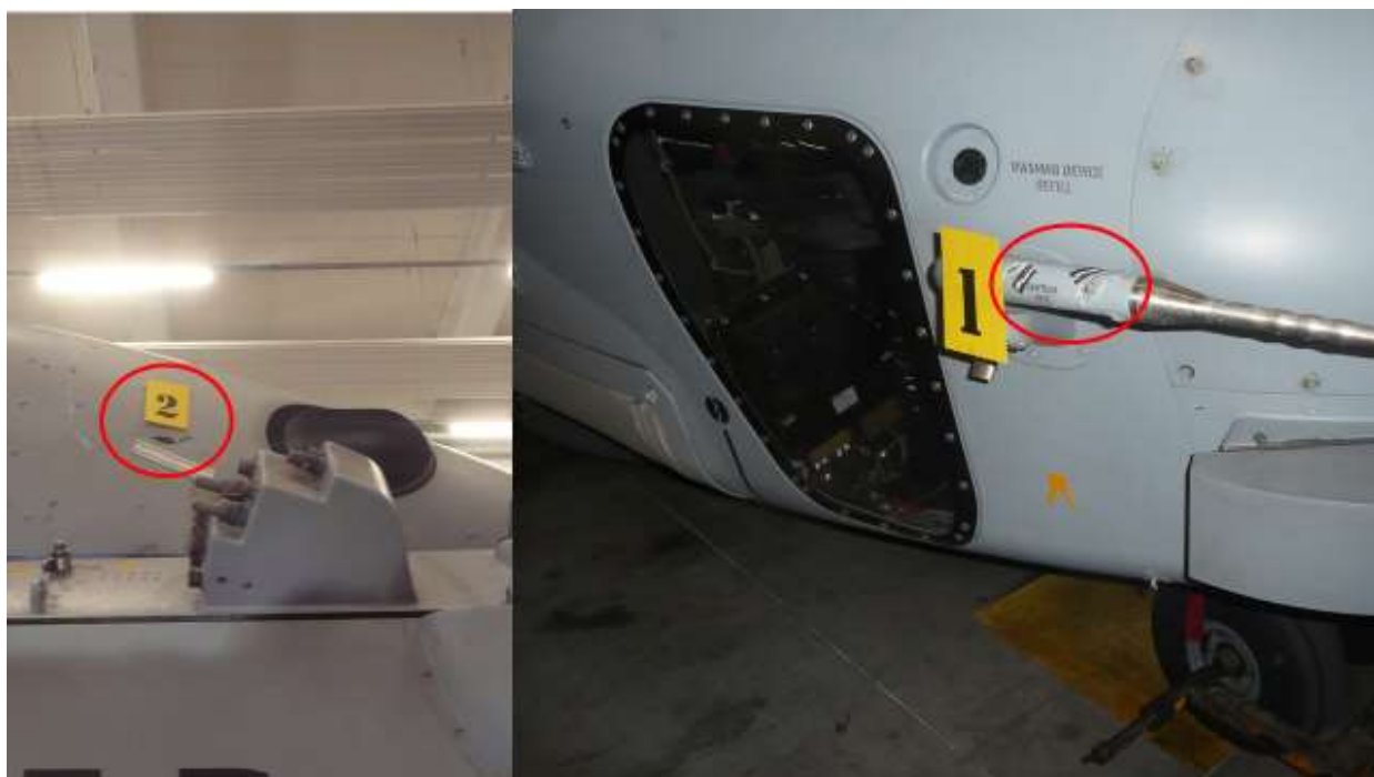
Figure 4 : vues d'impacts sur la cellule
