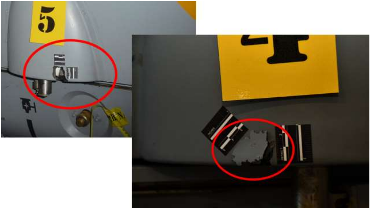
Figure 5 : vues d'impacts sur le carénage
