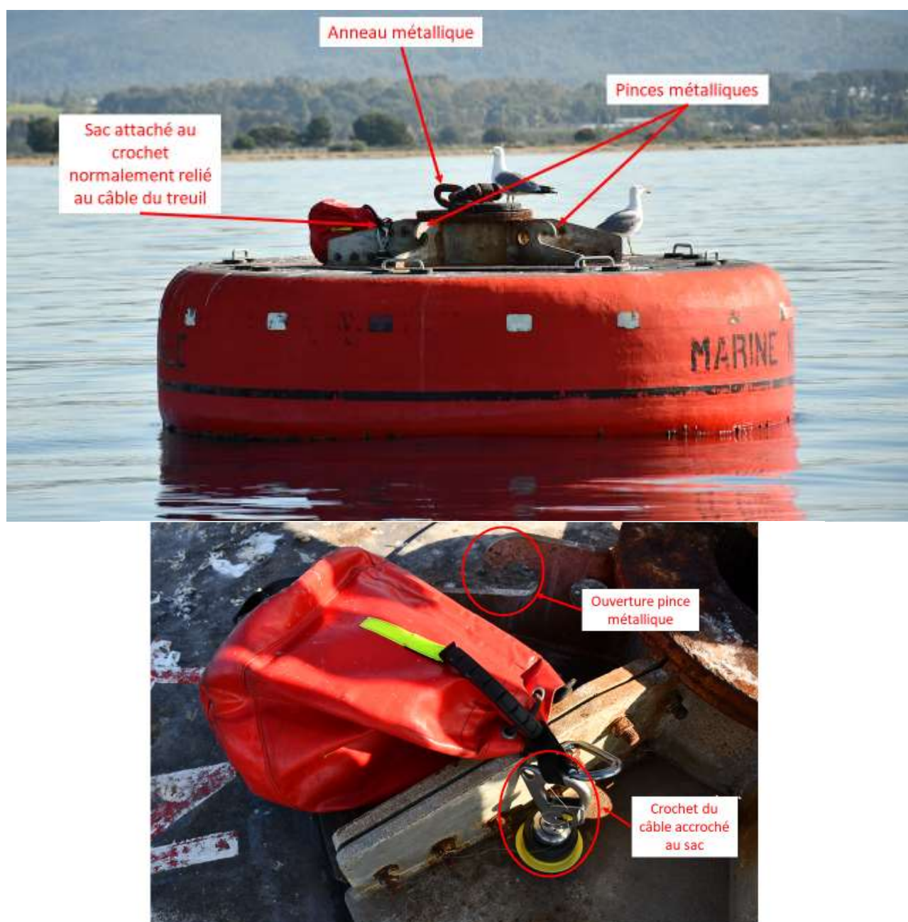
Figure 13 : description du coffre
