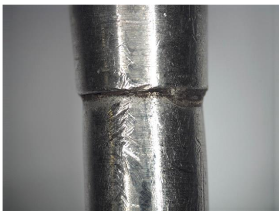
Figure 18 : marquages et éraflures
