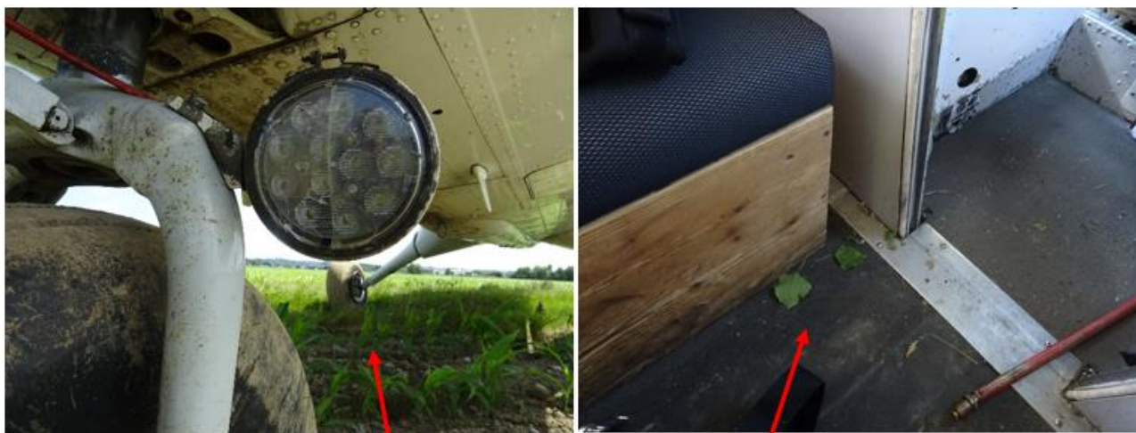
Figure 8 : phare d'atterrissage endommagé / végétation à l'intérieur de l'appareil
