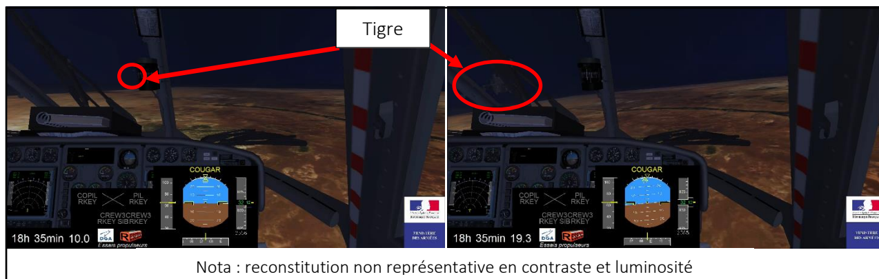
Figure 16 : points de vue du pilote du Cougar 10 secondes (à gauche) et 1 seconde (à droite) avant l'abordage
