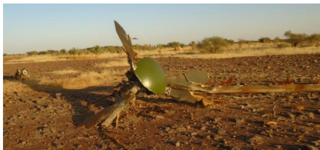
Figure 12 : queue du Cougar, à gauche ; à droite, rotor principal et boîte de transmission principale
