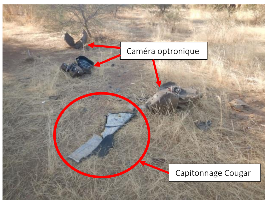
Figure 10 : caméra optronique en 3 fragments et capitonnage Cougar
