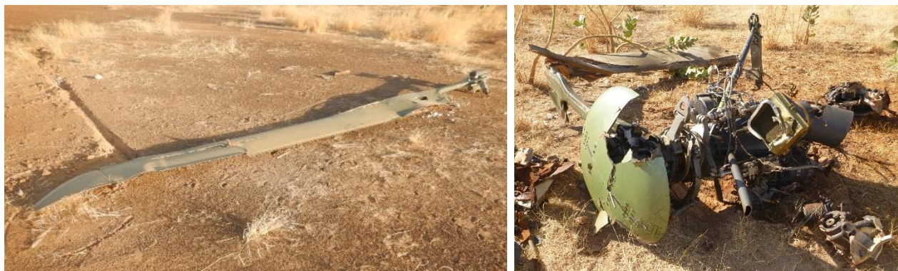
Figure 9 : pale entière à gauche, moyeu rotor avec une seule pale (vrillée) à droite
