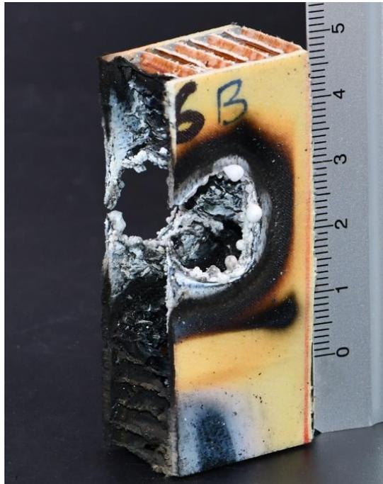
Figure 6 – Sandwich aéronautique après irradiation laser
