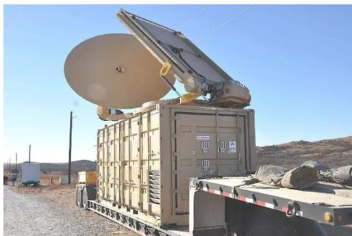
**High-Power-Electro-Magnetics (HPEM)** (Allemagne) (Diehl): Diehl a développé des sources HPM (générateur de Marx et oscillateur) dans des bandes supérieures à 1 GHz. Elles sont portables (voir photo). Les puissances générées vont de 50 kV (photo ci-contre) à 1 MV pour une station sol. Ici, le champ est de 50 000 V/m à 2 m, ce qui permet de stopper un véhicule à 10 ou 20m. A noter que le boîtier fait cage de Faraday pour préserver l'électronique lors des tirs.
