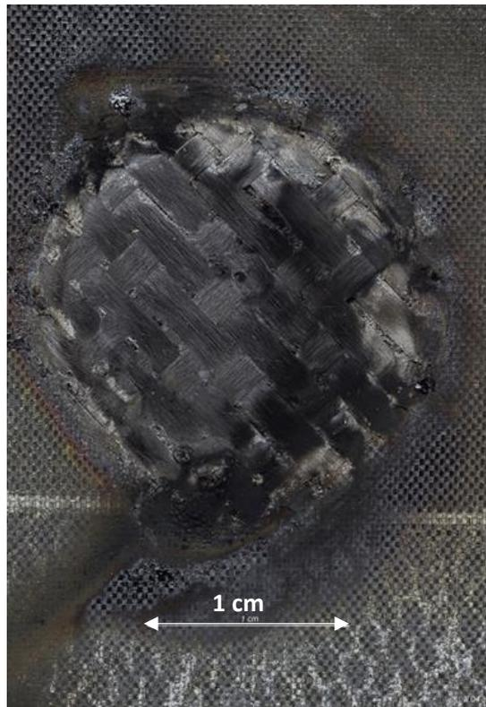
Figure 10: échantillon à 500 W/cm<sup>2</sup>
