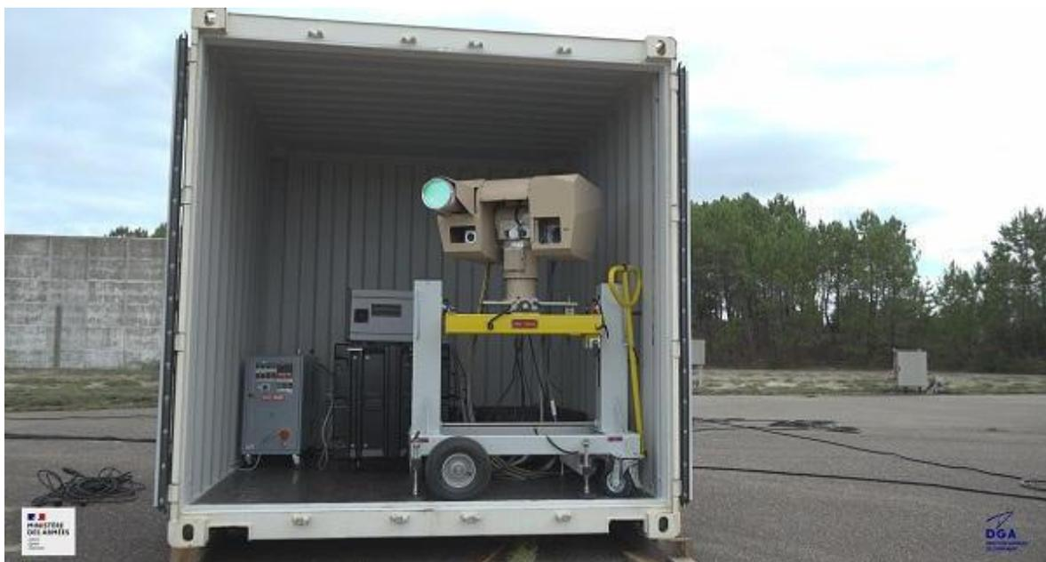
Figure 1– Système HELMA-P de CILAS, 2 kW (source DGA)
