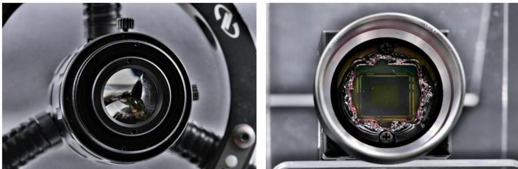
Figure 11- destruction d'un objectif, suite à une agression laser hors bande. La monture du capteur, en plastique, est également endommagée. Cependant, la caméra fonctionne toujours (avec un objectif neuf)
